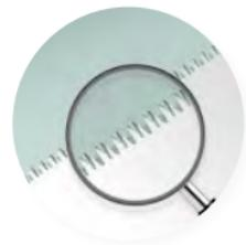
**Achtung!** Für Längsschnitte in Holz sollten Sie eine spezielle Dreiecksverzahnung verwenden. Diese finden Sie auf den meisten Ryoba-Sägen.
