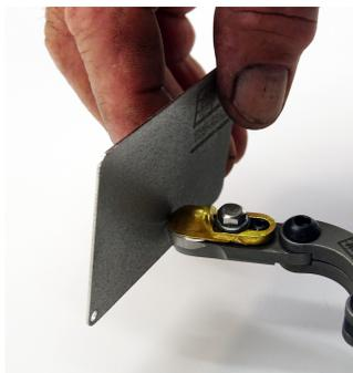
Schärfen des Pro-Forme Powerhead Schneidkopfes mit einem Diamant-Schleifstein
