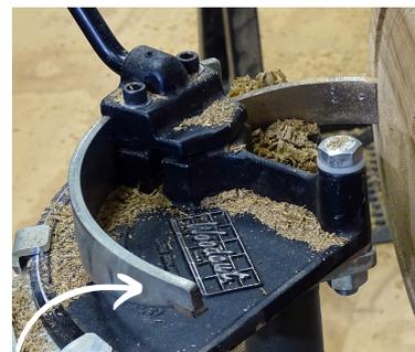
*Hinweis: Stellen Sie für eine optimale Stabilität sicher, dass Mitnehmer, Drehpunkt des Bowlsavers und Reitstock fluchten (siehe gelbe Linie unten). Der Drehpunkt kann verändert werden, um unterschiedlich geformte Schalen herzustellen. Dies führt allerdings zu einer geringeren Stabilität während des Ausstechens.*
