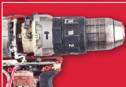
Beispiel für übermäßigen Verschleiß
